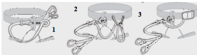
Рис. 38 – Кріплення амортизатора фрикційного типу дії до ІСС
