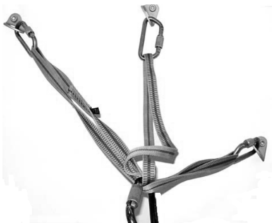
Рис. 99 – «Заклинена» компенсуюча петля
