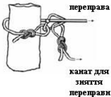
Рис. 120 – Закріплення канатів способом «удавка»
