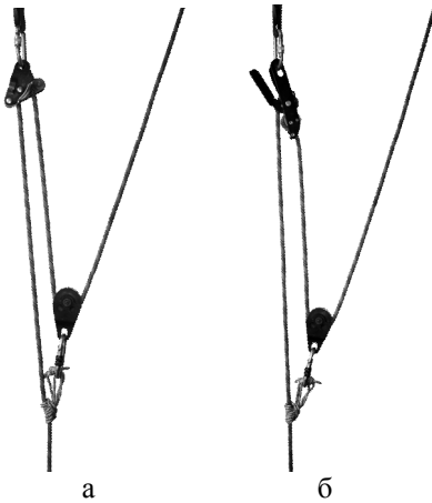
Рис. 139 – Використання автоматичних страхувальних – Gri-gri (а) та автоматичних спускових – Stop (б) пристроїв для автоматичної фіксації поліспасти
