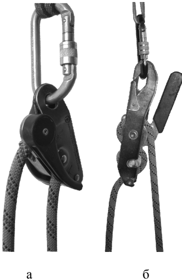
Рис. 123 – Використання страхувальних пристроїв фрикційного типу в якості гальмівного пристрою в ГАС: а) «грі-грі», б) «стоп»
