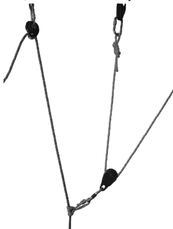
Рис. 131 – Поліспасти з окремого канату
