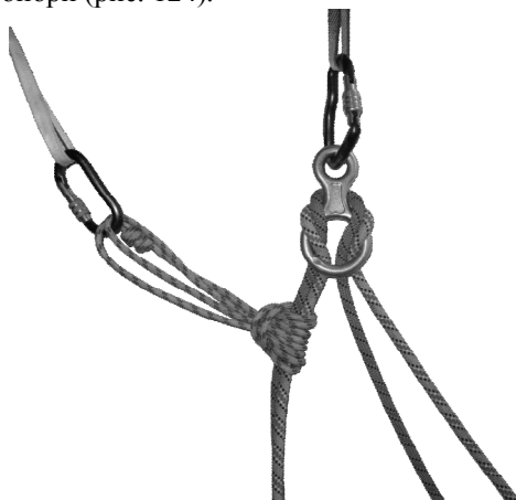
Рис. 124 – Застосування схоплюючого вузла з подвійного репшнура в якості додаткової страховки в ГАС
