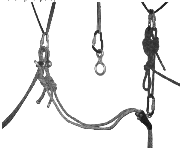
Рис. 126, в – Перенесення навантаження на страхувальний пристрій додаткової страхівки
