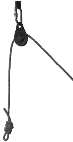
Рис. 128 – Невірна схема поліспасту
