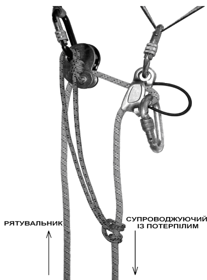
Рис. 149 – Система спуску потерпілого із супроводжуючим «гойдалка-противажиль»
