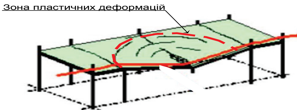
Рис. 1. Лінія утворених пластичних деформацій що розглядаються як рухомі механічні в'язі (пластичні шарніри)
