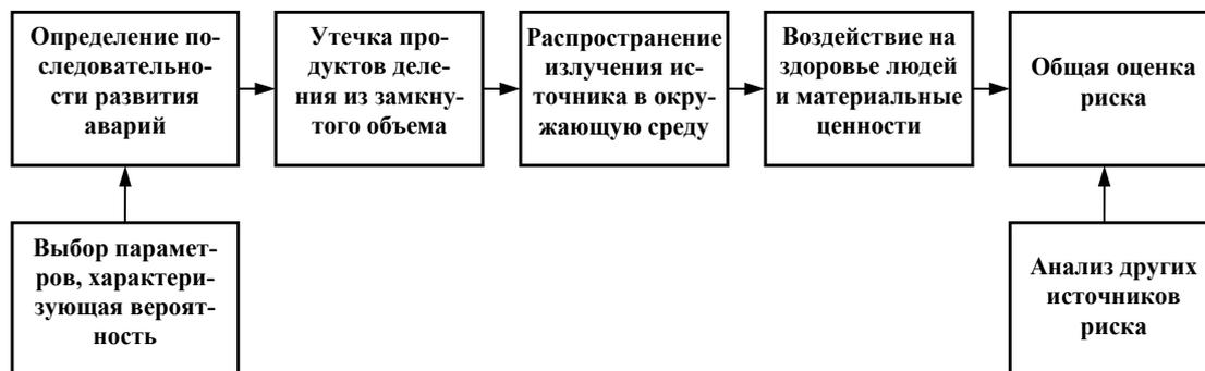
**Рис. 2 – Пример решения задачи анализа безопасности техногенного объекта (реактора)**
