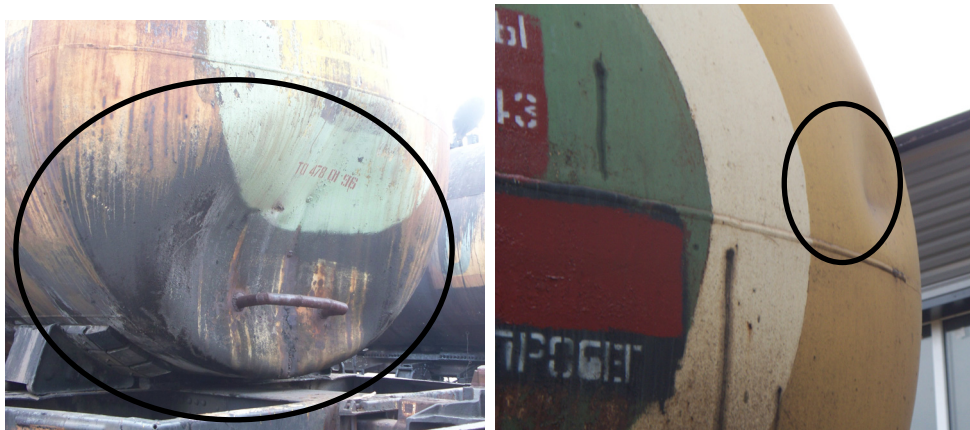
Рис. 1 – Дефекти котлів цистерн типу «вм'ятина»
