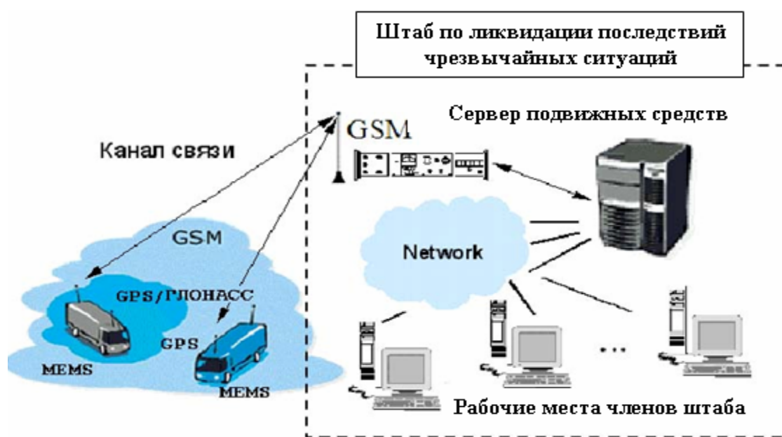
Рис. 1 – Интегрированная малогабаритная MEMS/GPS/ГЛОНАСС навигационная система контроля и управления подвижными средствами
