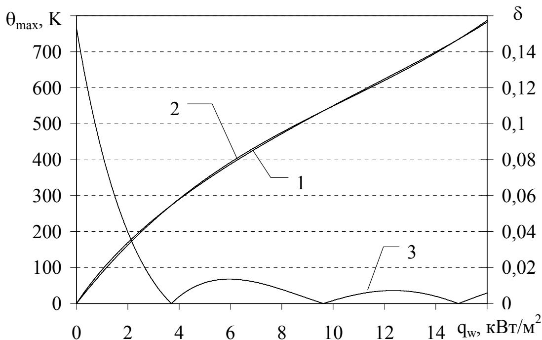
Рис. 1 – Зависимость максимально достижимого прироста среднеобъемной температуры в помещении \theta_{\max} в зависимости от плотности теплового потока на ограждающие конструкции q_w : 1 – решение трансцендентного уравнения (8); 2 – аппроксимация полиномом 3-й степени; 3 – относительная погрешность \delta (по правой оси)
