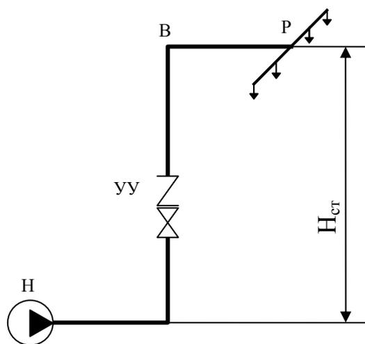
**Рис. 1** – Расчетная схема распределительной сети: Н – насос; УУ – узел управления; В – точка ввода; Р – расчетная точка
