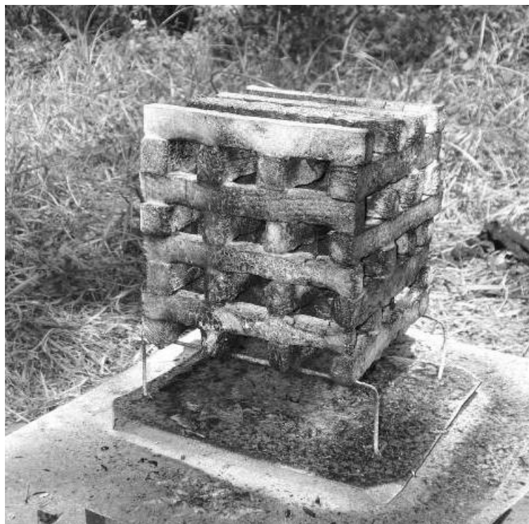
Рис. 3 – Модельне вогнище після гасіння ГУС \text{CaCl}_2 11,4% – \text{Na}_2\text{O}\cdot 2,95\text{SiO}_2 3,8% – \text{H}_2\text{O} 84,8%.
