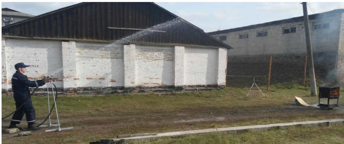
Рис. 4. Подача двух струй ГОС на модельный очаг 1А
