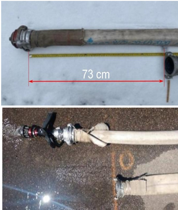
Рис. 19 – Фрагменти експериментів з визначення подовження напірних пожежних рукавів
