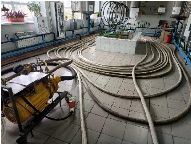
Рис. 20 – Фрагмент експерименту з дослідження енергетичних втрат при транспортуванні вогнегасних рідин
