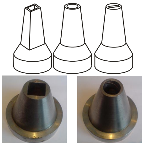
Рис. 6 – Приклади насадок із квадратним, кругло гвинтовим і щілинним перерізами
