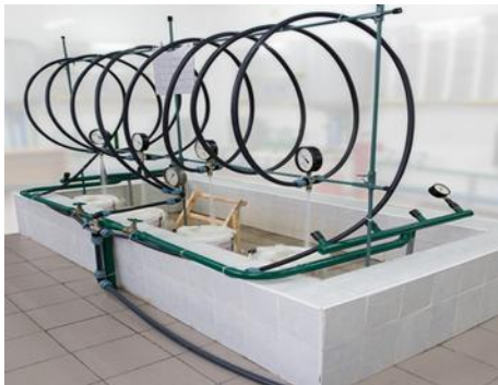
Рис. 18 – Стенд моделювання течії рідини із змінною вздовж потоку масою
