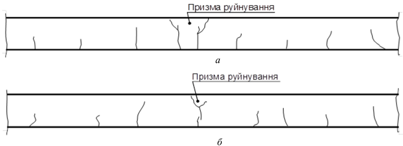
Рис. 3. Форма та характер розподілу тріщин у бетоні зразків залізобетонних плит, підданих вогневим випробуванням у момент перед руйнуванням одного із зразків: a – зразок № 1; б – зразок №2
