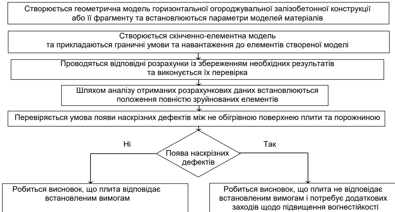
Рис. 20. Схема алгоритму реалізації уточненого методу вогнестійкості при неявному та явному інтегруванні для горизонтальних огорожувальних залізобетонних конструкцій за граничним станом втрати цілісності
