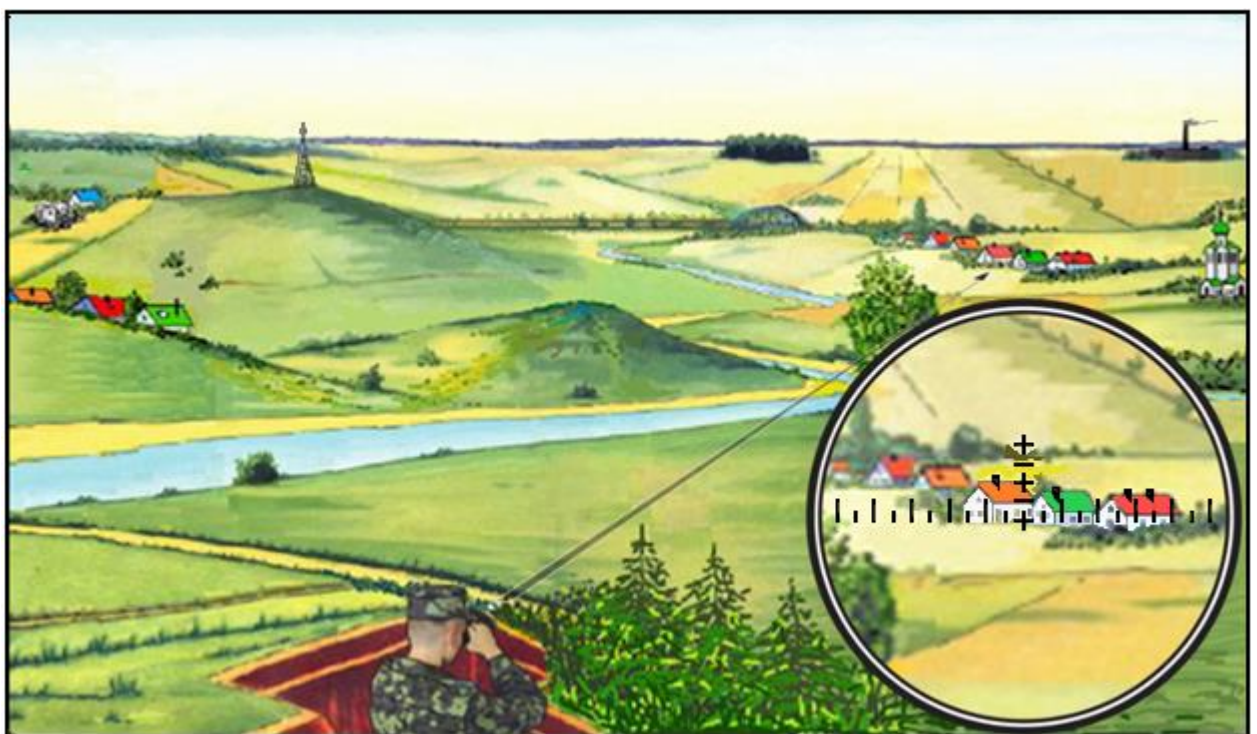
Рис. 1.10. Визначення відстані за шкалою бінокля
