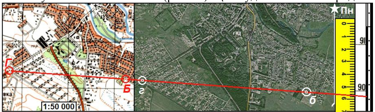
Рис.4.3. Нанесення істинного і магнітного меридіана на аерознімок
