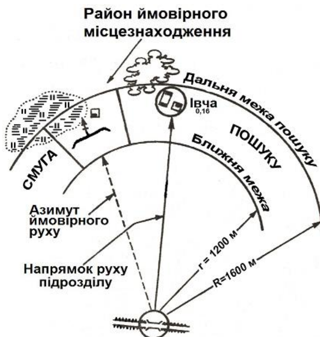
Рис. 2.15. Відновлення орієнтування графічним способом
