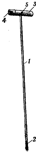
Мал. 52. Приладдя автомата (кулемета), підготовлення для чищення: 1 – шомпол; 2 – протирка; 3 – пенал; 4 – викрутка; 5 – головка шомполу
