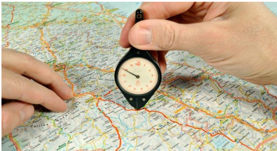
Рис. 11 – Спосіб вимірювання за допомогою курвіметру.
