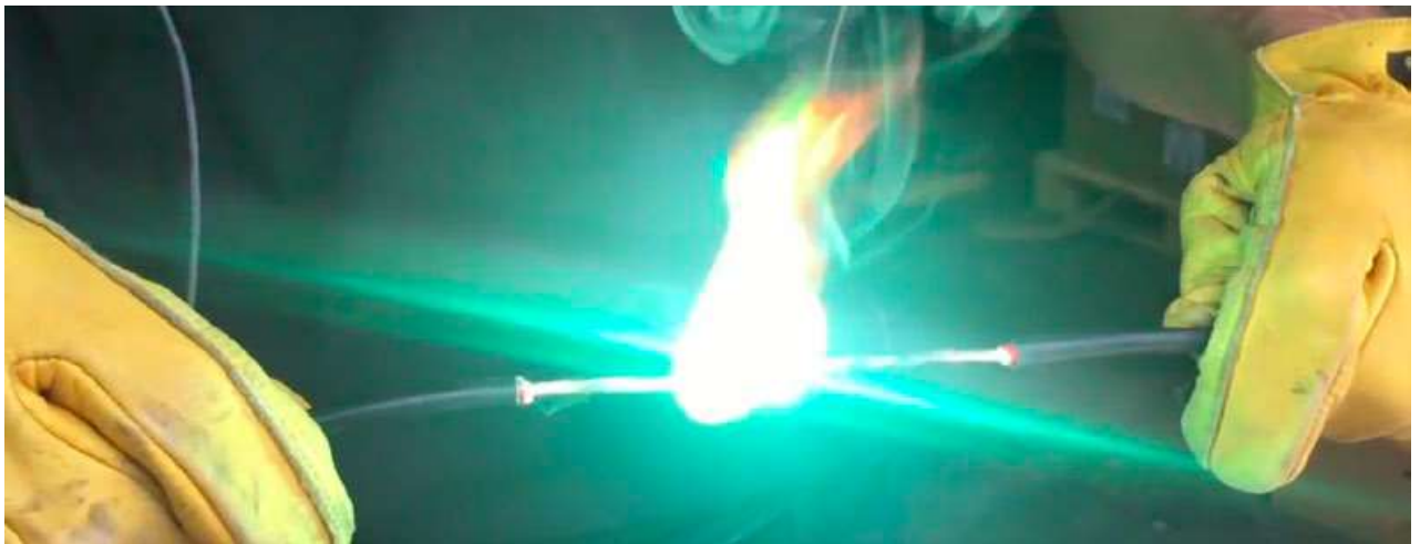
Електрична дуга виготовлена з 4 фотоелектричних модулів (потужністю 1 кВт)
