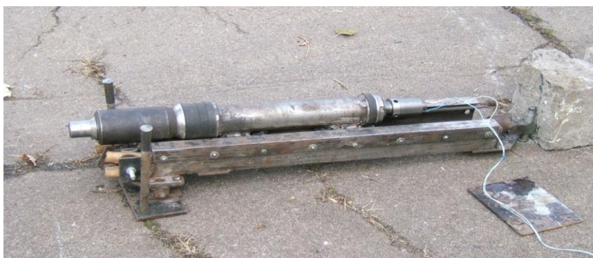
Рис. 1. Экспериментальный образец водяной системы пожаротушения импульсного действия
