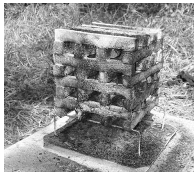
Рис. 2 Модельне вогнище після гасіння ГУС \text{CaCl}_2 11,4% – \text{Na}_2\text{O} \cdot 2,95\text{SiO}_2 3,8% – \text{H}_2\text{O} 84,8%.
