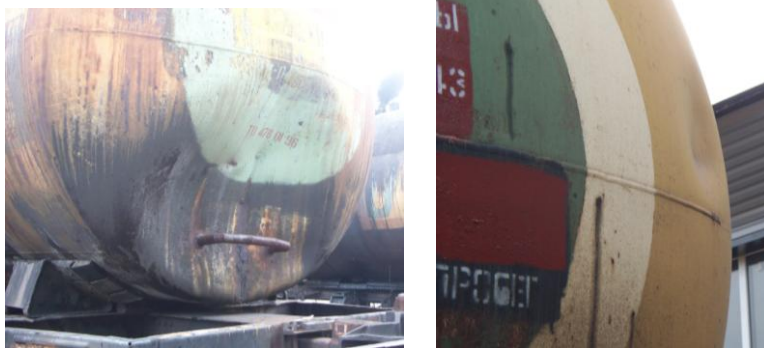
Рис. 1 – Фотографии повреждений цистерн типа «вмятина»
