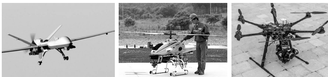
Рис. 1. БПЛА на базах самолета, вертолета и многороторного летательного аппарата.
