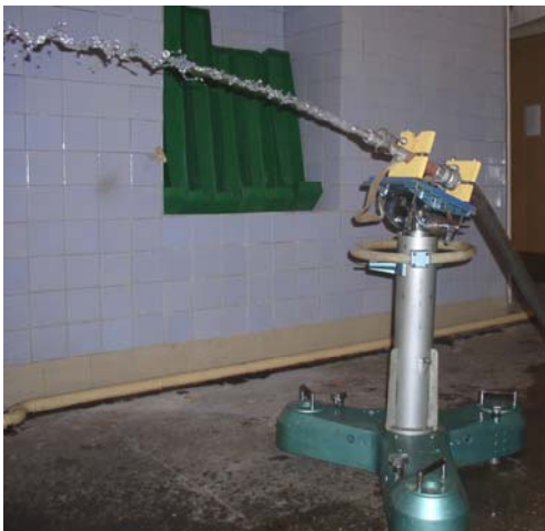
Рис. 1. Стенд для дослідження руху пожежних струменів
