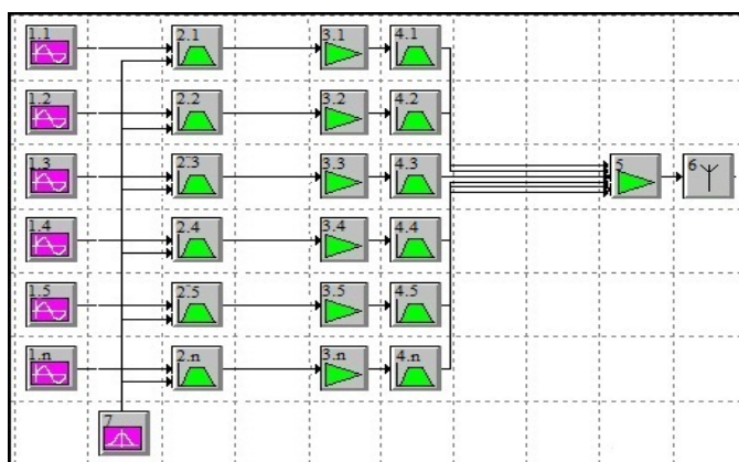
Рис. 1. Упрощенная функциональная схема адаптивного генератора шума.
