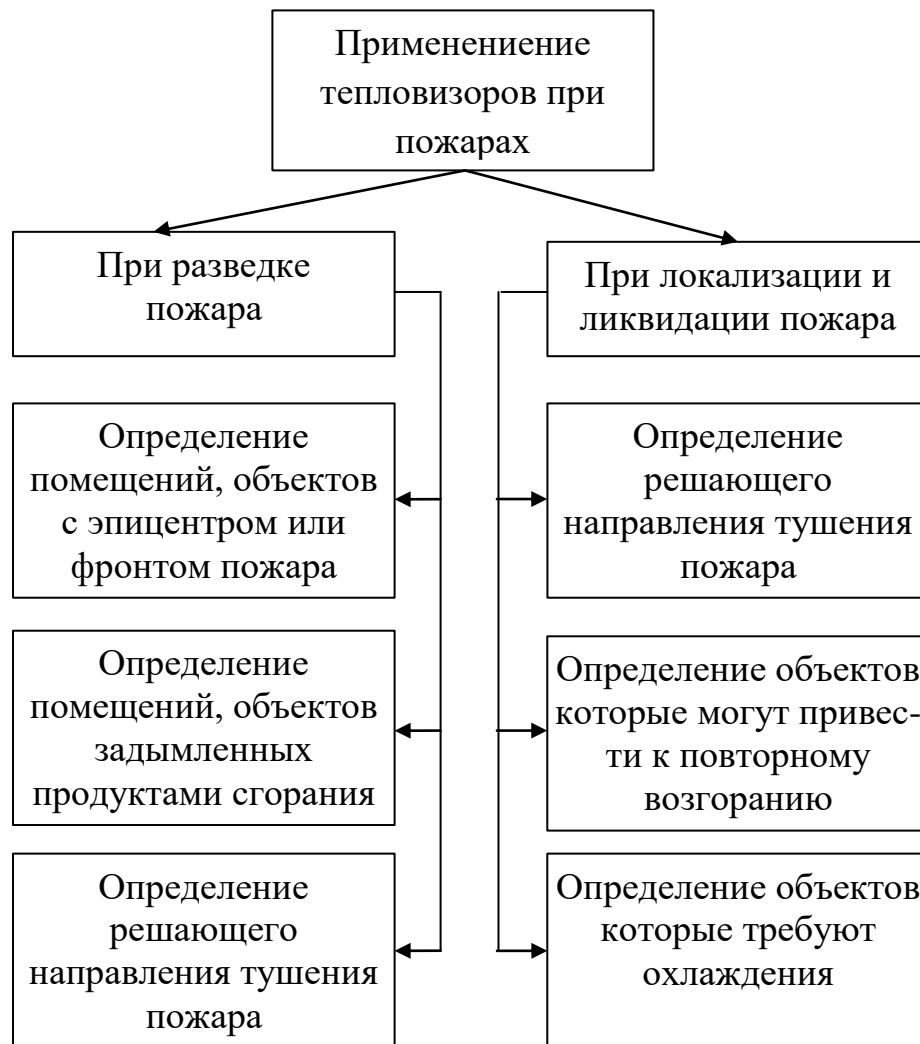
Рис. 2. Классификация областей применения тепловизоров пожарными подразделениями [8–10]
