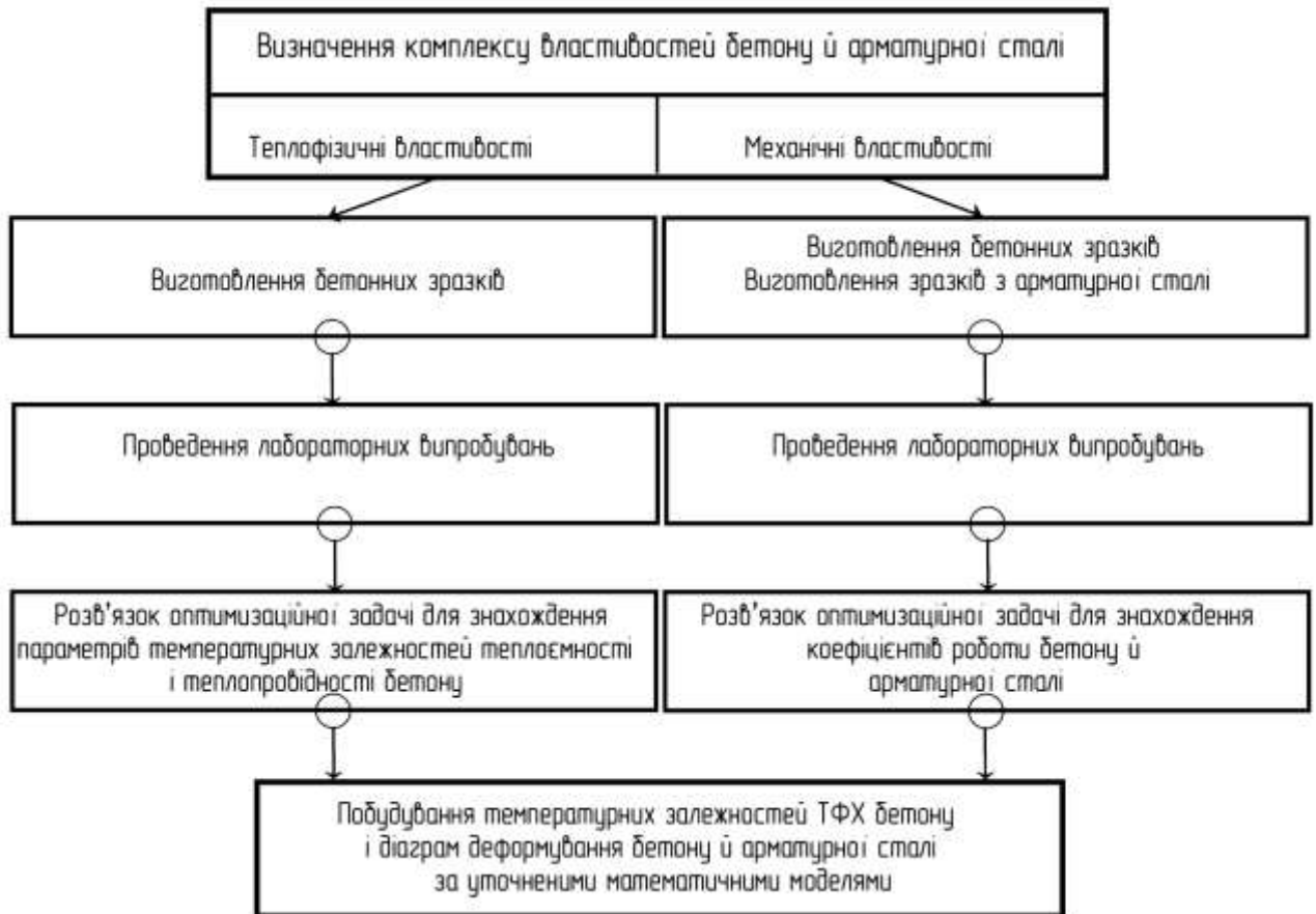
Рисунок 1. Структурна схема експериментально-розрахункового методу визначення комплексу теплофізичних і механічних властивостей бетону і арматурної сталі.
