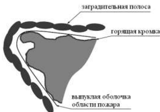
Рис. 1. Схема построения заградительной полосы перед фронтом лесного пожара
