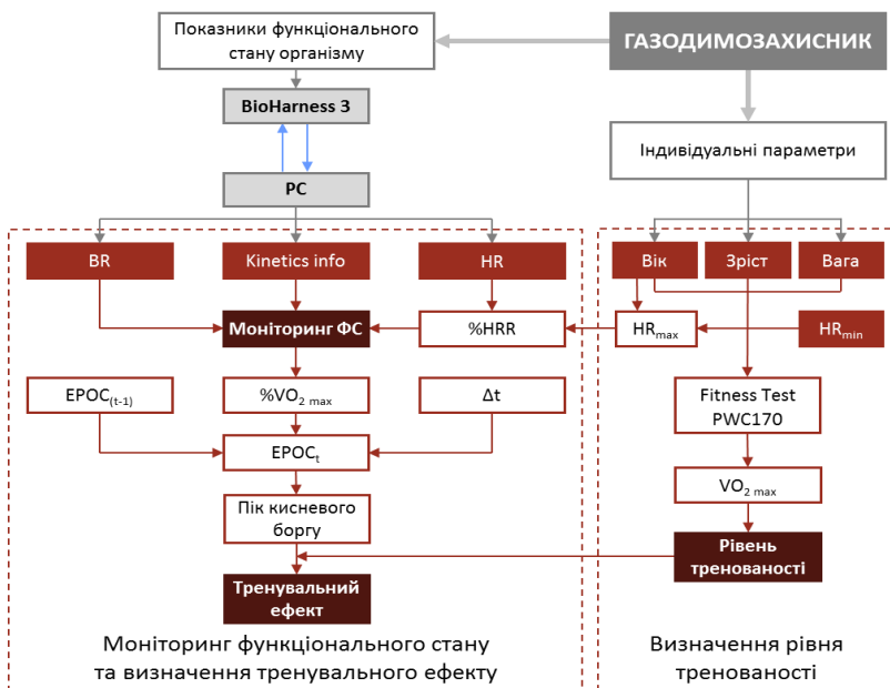
Рисунок 1 – Функціональна схема автоматизованої системи дистанційного моніторингу функціонального стану організму газодимозахисника
