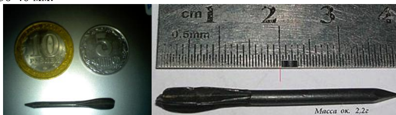
Рисунок 1 – Стрілоподібний забійний елемент довжиною 4 см, представляє собою: загострене циліндрове тіло з оперенням, яке призначене для стабілізації елемента у польоті; швидкість елемента, у момент спрацьовування снаряда, близько 200-300 м/с
