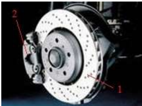
Рис. 1. Дисковий гальмівний механізм: 1-гальмівний диск, 2-суппорт з розташованими усередині гальмівними колодками
