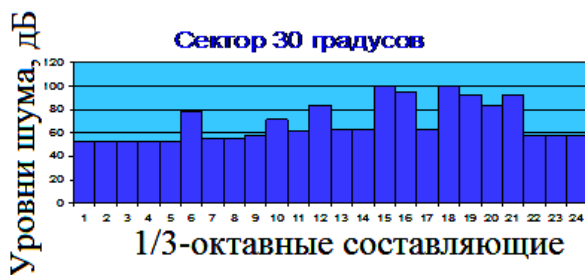
Рис. 3 – 1/3-октавные составляющие шума спроектированного вентилятора
