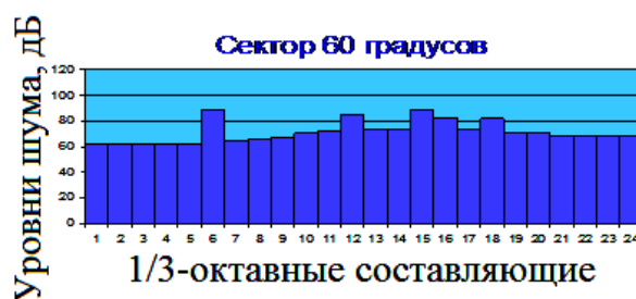
Рис. 3 – 1/3-октавные составляющие шума спроектированного вентилятора
