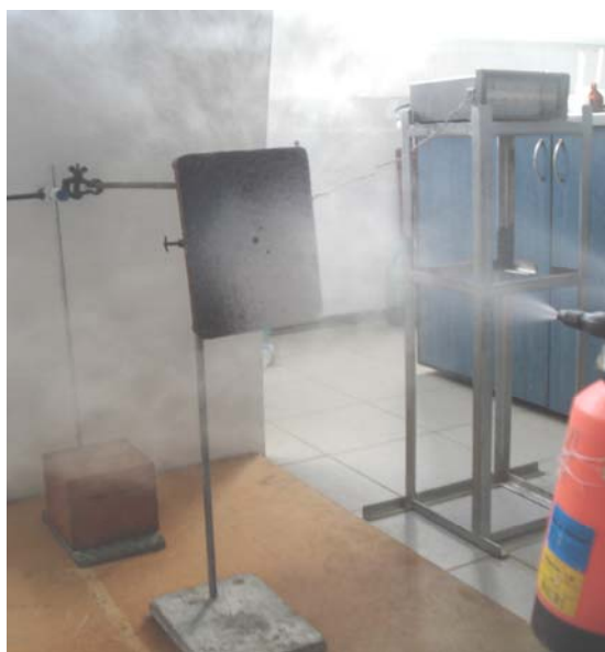
Рис. 1. Лабораторна установка для дослідження охолоджуючої дії ГУС
