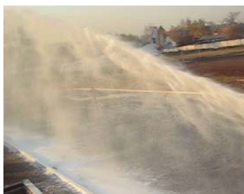
Рис. 2. Подача компресійної піни за допомогою ствола РС-50
