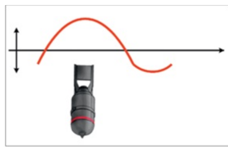
Рис. 2. Особливості сигналу ГМ при виявленні вертикально розташованого об'єкта
