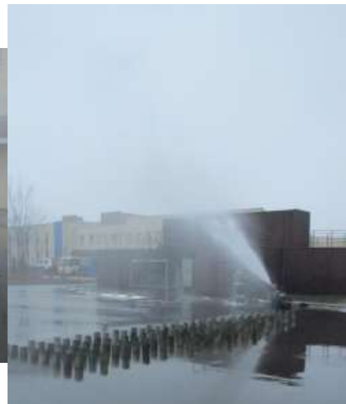
Рисунок 1 – Определение эффективной дальности распыленной струи ствола СПРУК 50/0,7 «Викинг»
