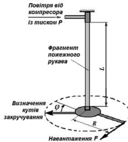
Рисунок 1 – Дослідна установка із встановленим фрагментом пожежного рукава
