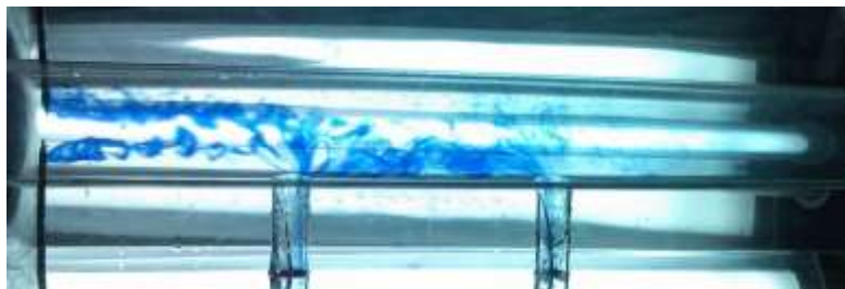
Рис. 1. Дестабилизация течения в потоке за насадкой с минимальным расходом из насадки
