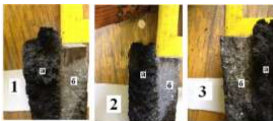
Рис. 1. Зразки після випробувань: а – спучений захисний шар; б – очищена і не пошкоджена деревина
