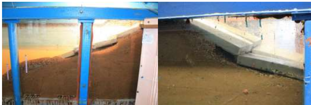
Рисунок 1. – Разрушение крепления откоса при волновом воздействии H=35 см и hв=6 см
