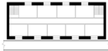
Рисунок 3. Не вірно трактування вимог. Громадська чотирьохповерхова будівля (гуртожиток), житловий п'ятиповерховий будинок з влаштуванням квартир, приміщень орієнтованих на дві поздовжні сторони будівлі.
