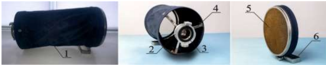
Рис. Будова ППГ: 1 – гнучкий циліндричний корпус; 2 – з’єднувальна головка; 3 – розпилювач; 4 – опорна вставка; 5 – набір латунних сіток; 6 – ручка для утримування.
