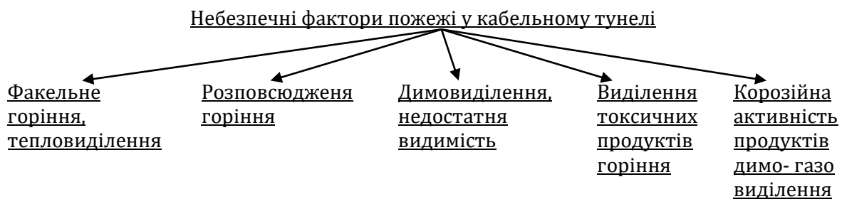
Рис. 1 – Небезпечні фактори пожежі у кабельному тунелі
