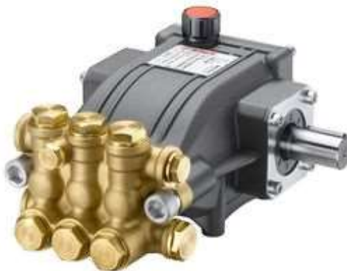
Рисунок 2 – Плунжерний триступеневий насос високого тиску
