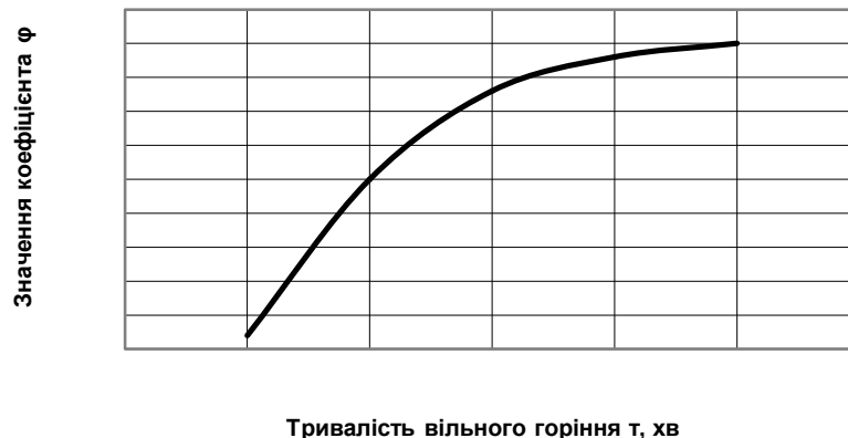
Рис. 2. Вплив тривалості вільного горіння при пожежі на значення коефіцієнта \varphi , який враховує частку теплового потоку, що переходить в огорожуючі конструкції
