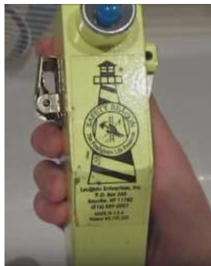
Рисунок 1 – Зовнішній вигляд пожежного світлового маячка «Safety beacon» (США)
