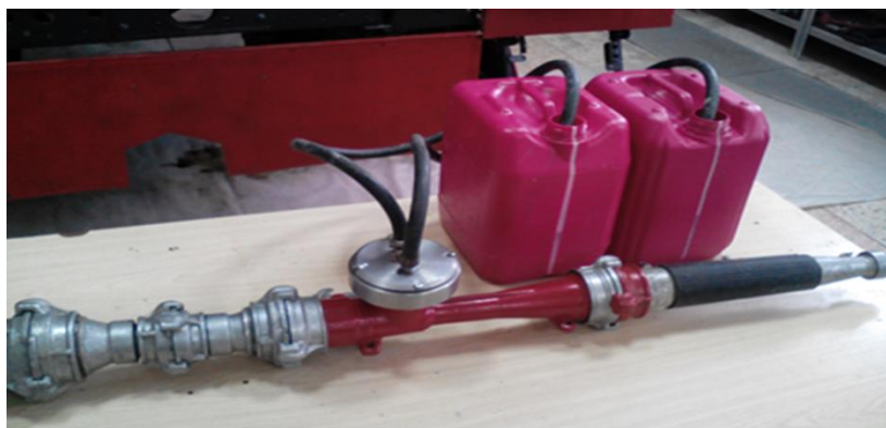
Рисунок 2 – Внешний вид портативного устройства эжекционного типа для получения огнетушащего геля
