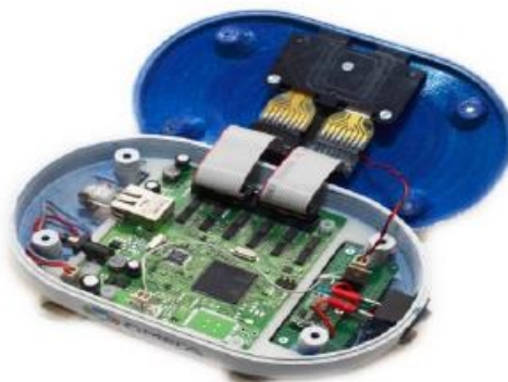
Рисунок 1 – Зовнішній вигляд газоаналітичної системи БПЛА
