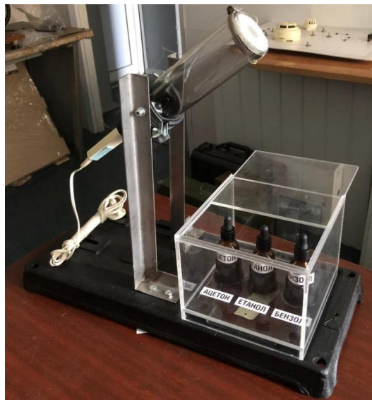
Рисунок 2 - Зовнішній вигляд модернізованого навчального пристрою для визначення нижньої концентраційної межі поширення полум'я парів горючих рідин
