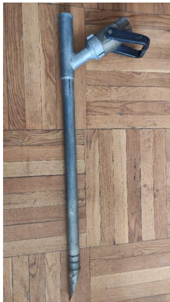
Рис. 2 – Пожежний пробивний ствол для гасіння автомобілів з наявними електричними чи гібридними елементами живлення
