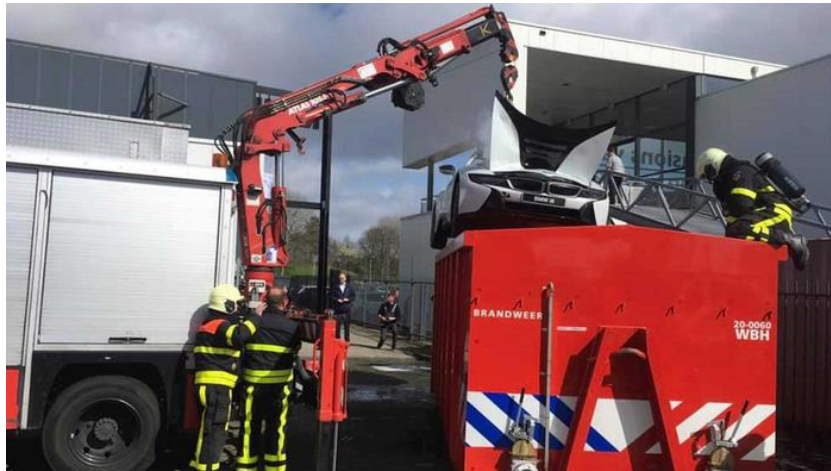
Рис. 1 – Пожежний автомобіль – контейнер для гасіння пожеж на електроавтомобілях, для повного занурення автомобіля за допомогою маніпулятора
