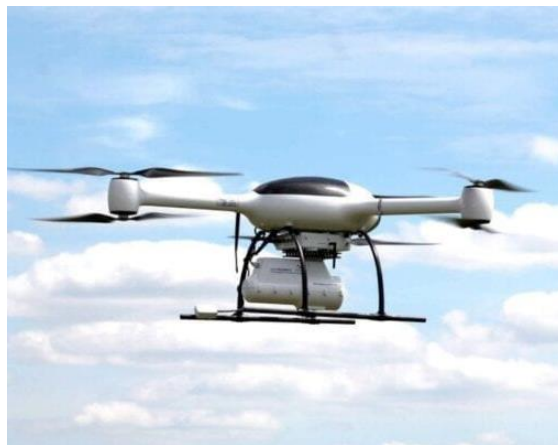
Рис. 2 – БПЛА BRUS для вимірювання рівня радіації
