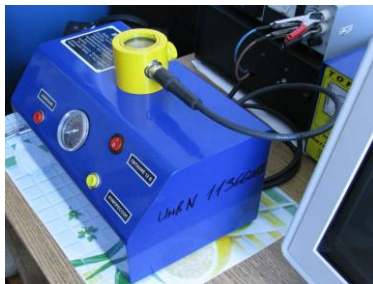
Фото 5. Стенд перевірки свічок запалювання під тиском.
