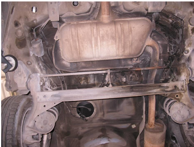
Фото. 1. Сліди термічного руйнування, що утворилися під днищем автомобіля у лівій його частині.
