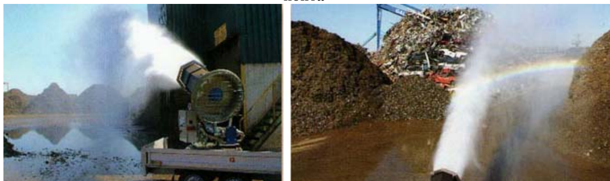
Рис. 1.3 – Создание водяной завесы, образуемой атомизатором
