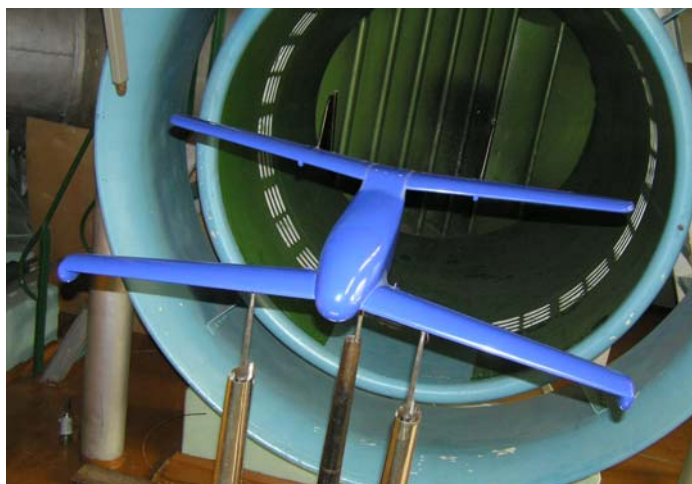
Рисунок 1. Масштабна модель БпЛА «Пчёлка К» в аеродинамічній трубі АТ-4 ХАІ
