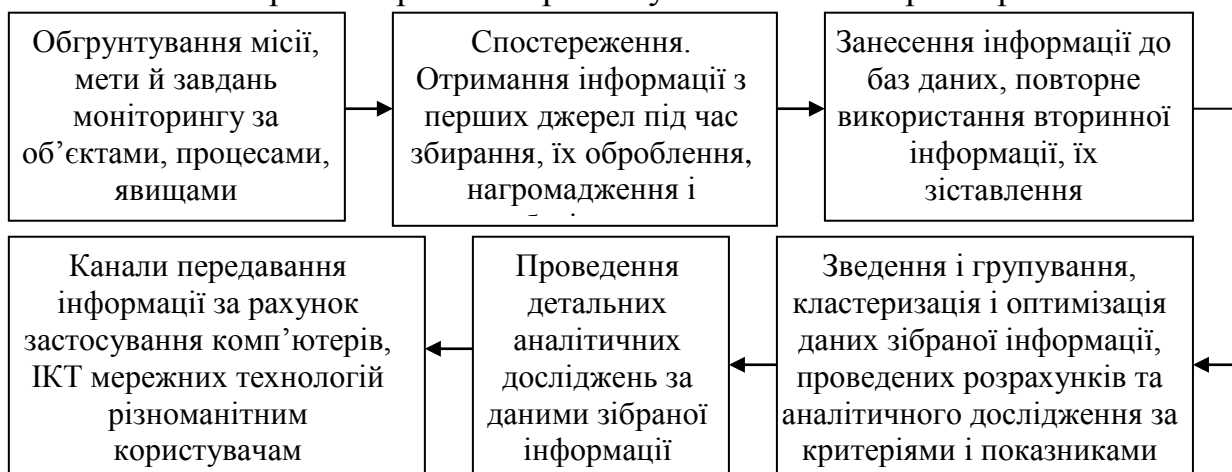
Рис. 4.5. Цикл оброблення інформації в автоматизованій системі моніторингу
