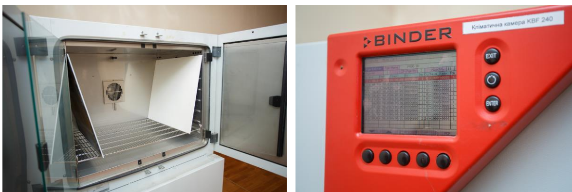
Рис. 6. Загальний вигляд кліматичної камери BINDER KBF 240
