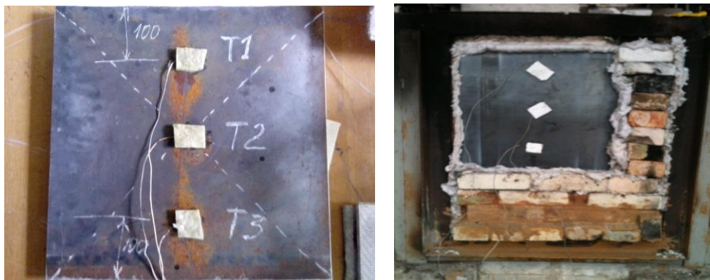
Рис. 7. Схема розміщення термопар з необігрівної поверхні пластини перед випробуванням
