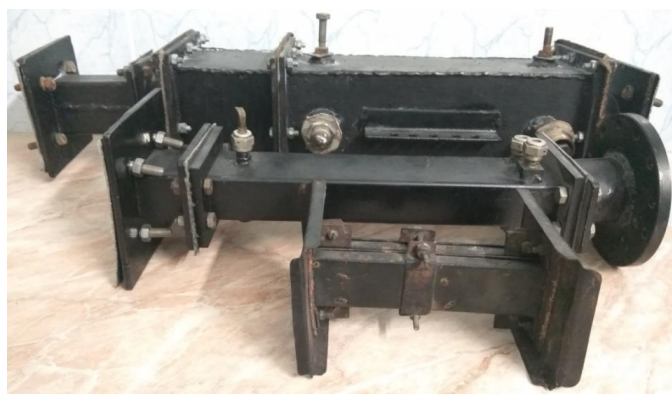
Рисунок 5.2 – Зовнішній вид діючого макета ФЕ ФТЧ з насипкою з природного цеоліту у сітчастих касетах [1, 5]
