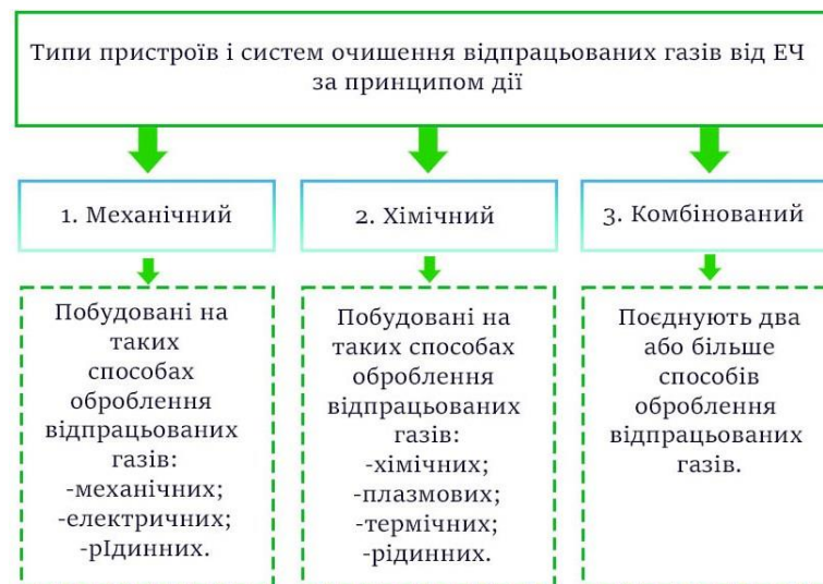
Рисунок 1.5 – Класифікація пристроїв і систем очищення відпрацьованих газів від твердих частинок за типами
