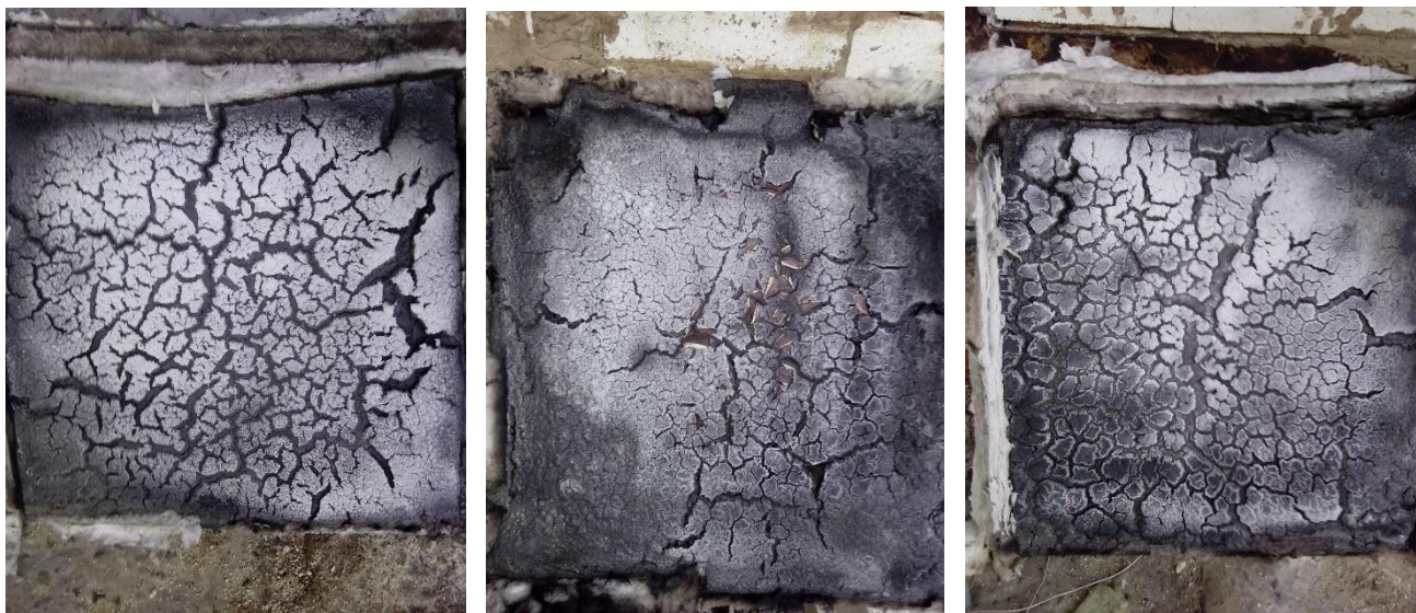
Рис. 2.20 Характерний вигляд вогнезахисного покриття після кліматичного та вогневого впливу
