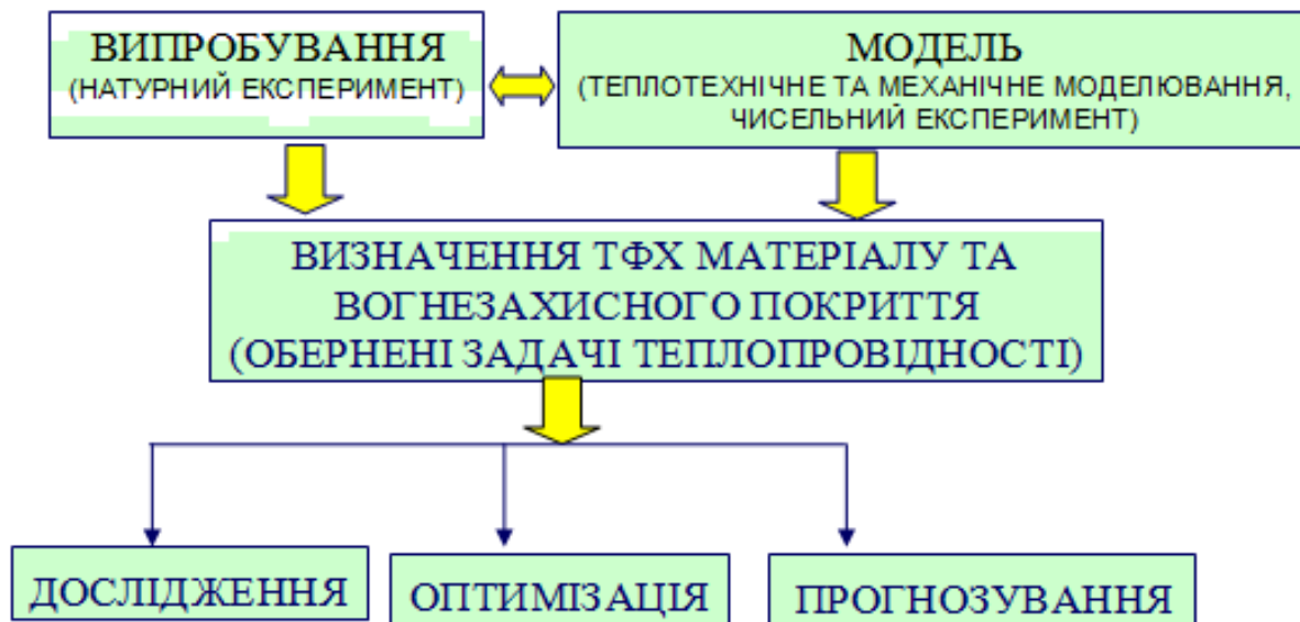
Рис. 1.4 Структурно-логічна схема розрахунково-експериментального методу
