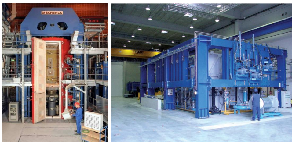
Рис. 1.5 Загальний вигляд вертикальної випробувальної печі
