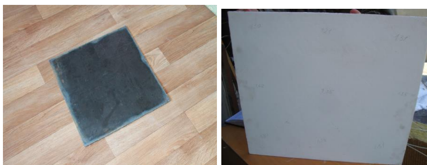
Рис. 2.15 Вигляд зразків: a – до нанесення вогнезахисної речовини; б – після нанесення вогнезахисної речовини
