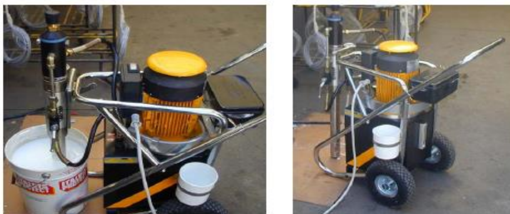
Рис. 2.22 Загальний вигляд агрегату безповітряного розпилення
