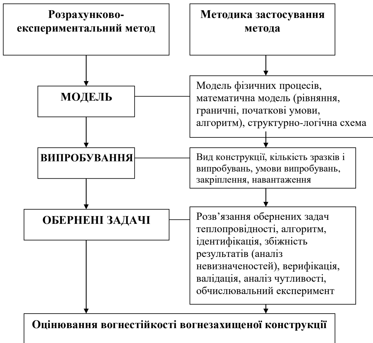
Рис. 2.7 Структурно-логічна схема розрахунково-експериментального методу і процедура його реалізації
