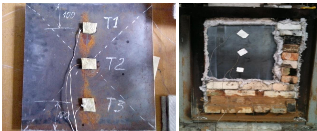
Рис. 2.16 Схема розміщення термопар з необігрівної поверхні пластини перед випробуванням
