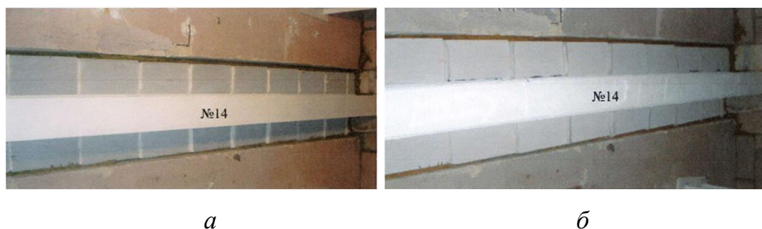
Рис. 4.35 Вигляд зразків навантаженої вогнезахищеної сталевій балки (№ 14) в печі до (а) та після (б) проведення випробувань з мінімальним значенням товщини вогнезахисного покриття
