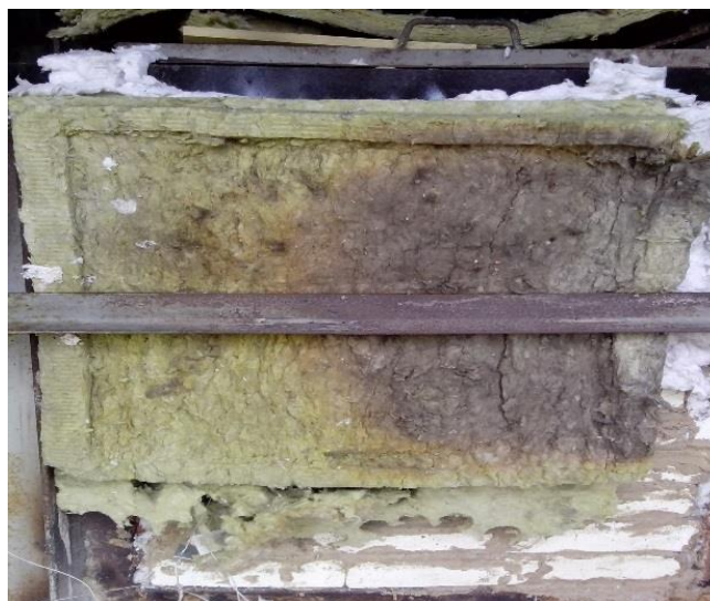
Рис. 2.17 Вигляд зразка з необігрівної поверхні пластини
