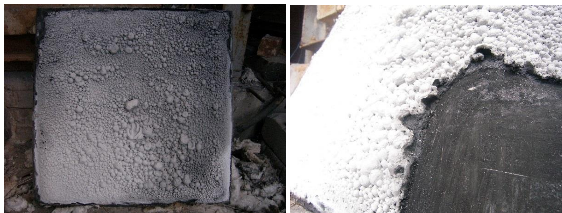
Рис. 2.27 Загальний вигляд вогнезахищеної пластини з покриттям «Amotherm Steel Wb» після випробувань
