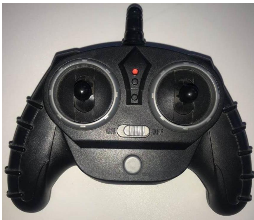
Рис. 6.5 – Фотозображення пульта керування розробленого діючого зразка безпілотної рухомої платформи
