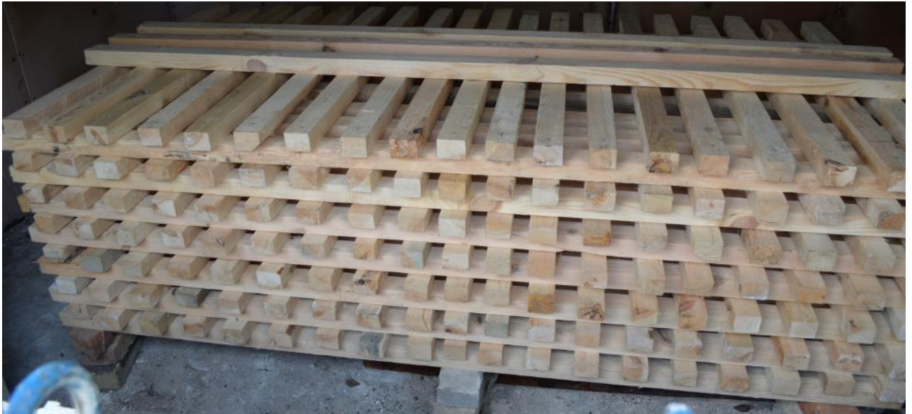
Рисунок 4.14 – Фото штабеля пожежної навантаги, що встановлюється у вогневій камері
