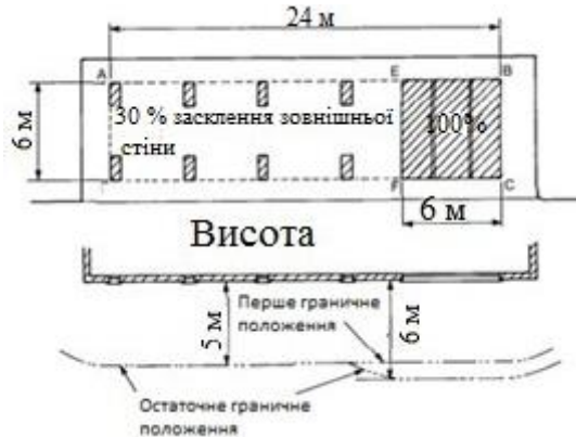
Рисунок 1.4 – Приклад визначення протипожежної відстані у разі різної площі отворів у зовнішній стіні будинку
