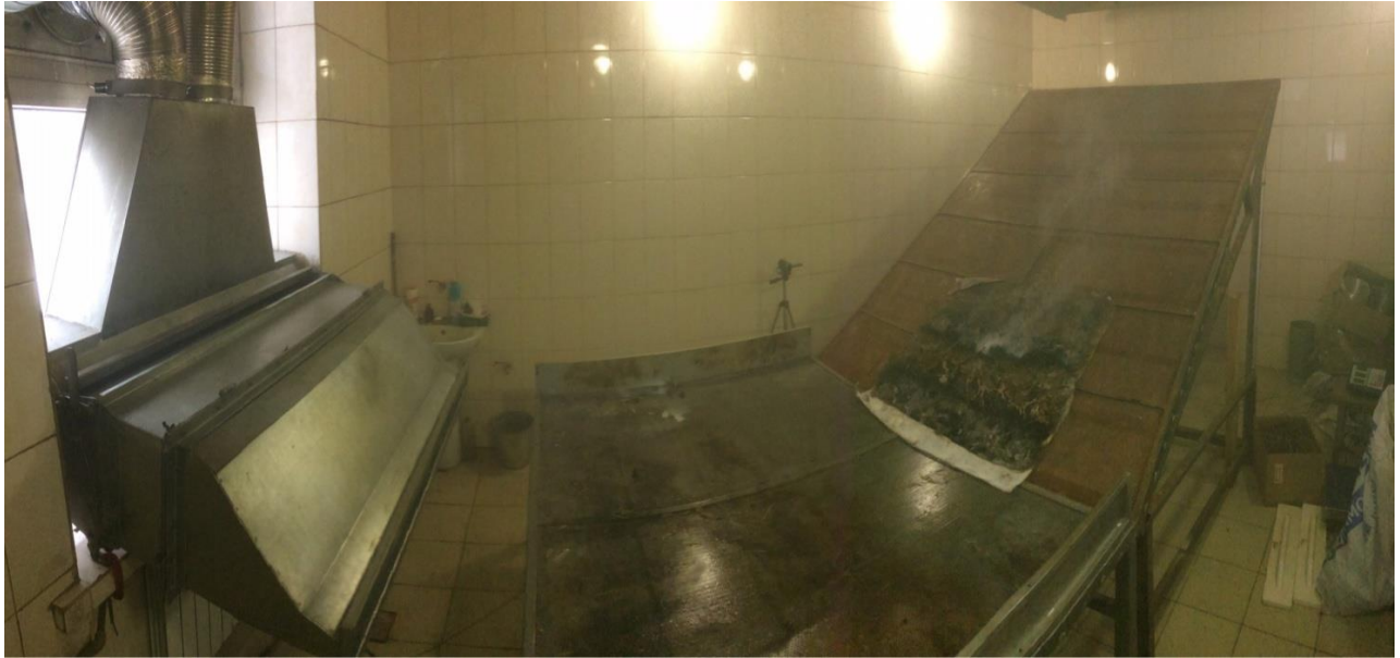
Рис. 3.11 Загальний вигляд установки для імітації потоку посітря з різною швидкістю та рельєфу
