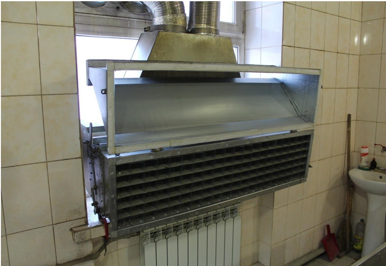
Рис. 3.12 Установка для імітації потоку повітря з різною швидкістю
