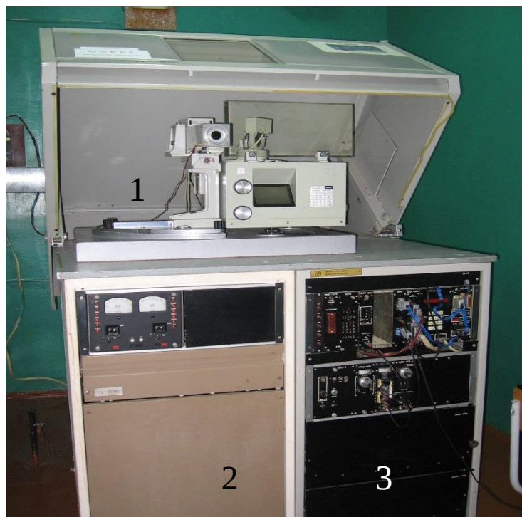
Рисунок 2.3 – Загальний вигляд дифрактометра рентгенівського ДРОН – 3М: 1 – джерело рентгенівського випромінювання ИРИС – 0; 2 – комплекс керуючий дифрактометричний КУД – 1; 3 – захист
