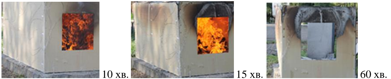
Рис. 10. Зовнішній вигляд моделі серії П.А.2 на різних етапах випробувань
