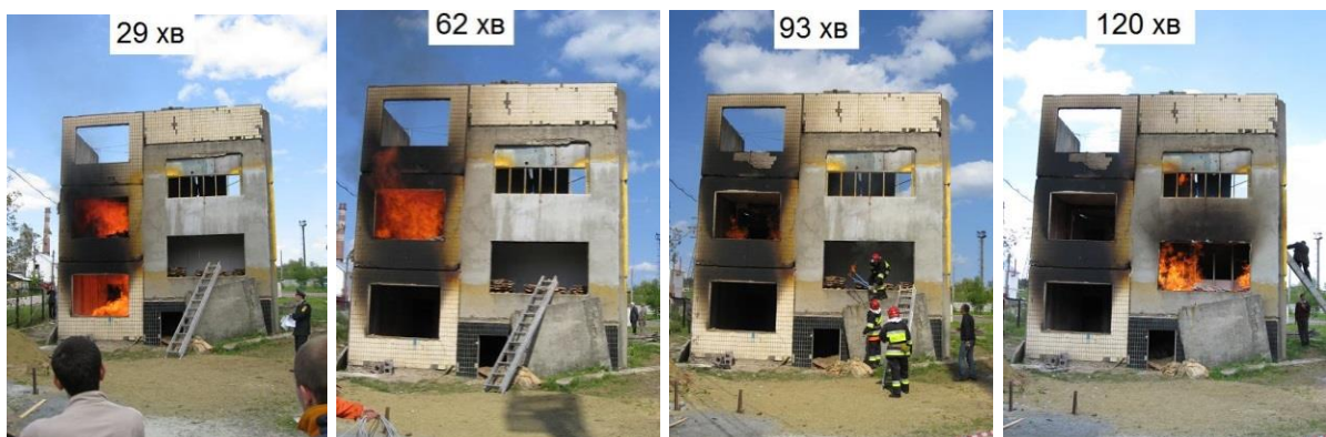
Рис. 7. Розвиток пожежі у натурних моделях приміщень при проведенні першого та другого дослідів
