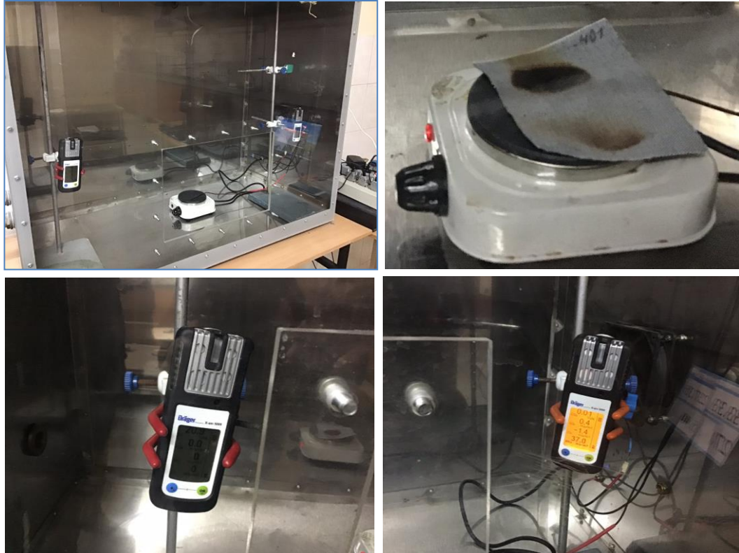
Рис. 5.1 – Лабораторна установка для визначення димо- та газоутворення під час нагрівання зразків текстильних матеріалів
