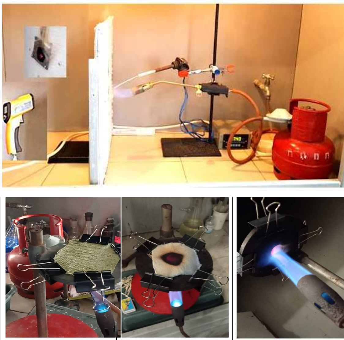
Рис. 3.1 – Лабораторна установка для випробувань зразків текстильних матеріалів на вогнестійкість
