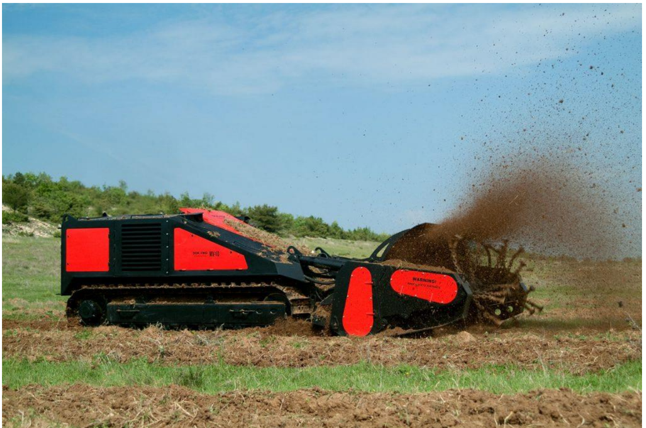
Рисунок 4.3 – Машина для дистанційного розмінування DOK-ING MV-10 (Хорватія)
