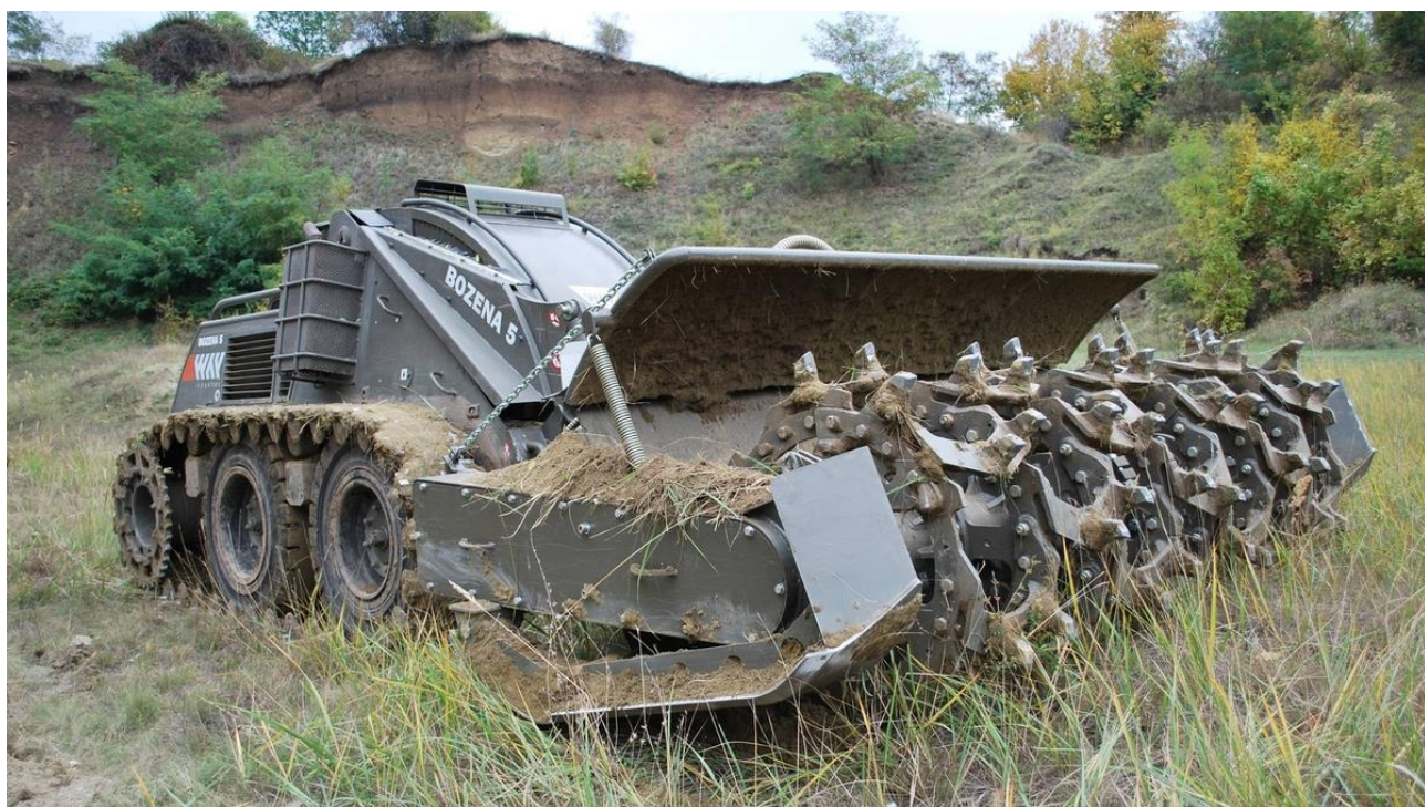
Рисунок 4.2 – Машина для дистанційного розмінування Bozena 5 (Словаччина)
