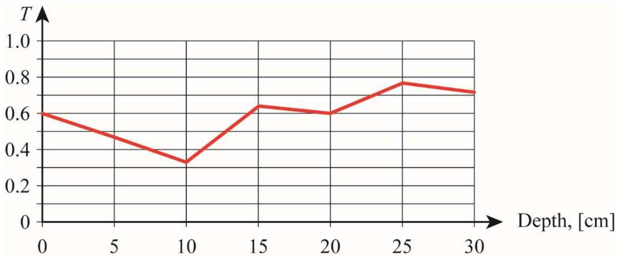
Рисунок 3.12 – Залежність значення логарифмічного пропускання від глибини розташування зразка ґрунту для Fe 2 O 3
