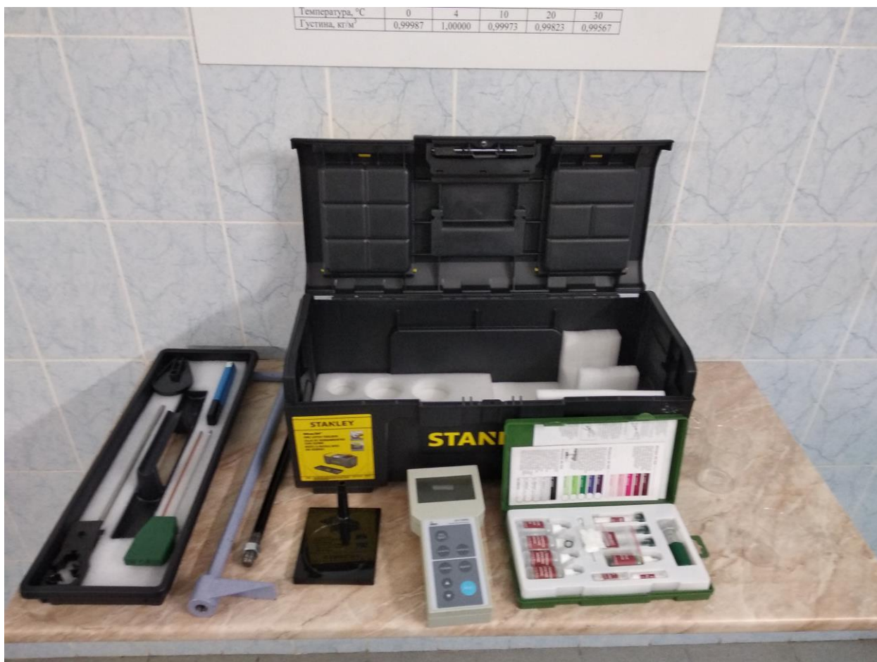
Рисунок 4.7 – Загальний вигляд мобільного комплексу польових досліджень ґрунту
