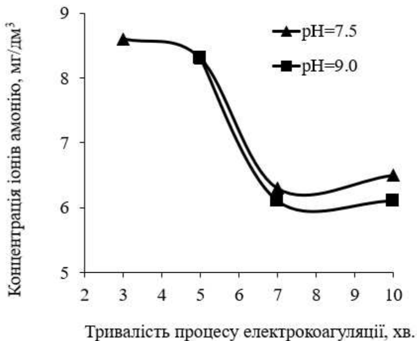
Рис. 3.10 Графік залежності концентрації іонів амонію в очищеній стічній воді від рН середовища та тривалості процесу електрокоагуляції
