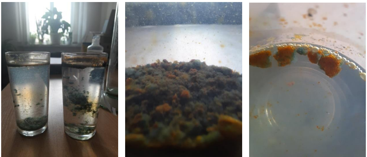
Рис. 3.5 Стічні води оброблені методом електрокоагуляції з використанням сталевих електродів
